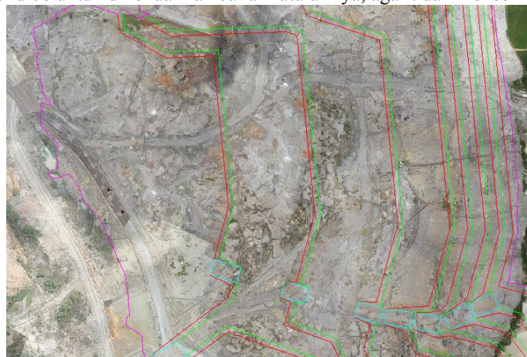
Gambar 14. Kondisi akhir penimbunan Sedpond 01
