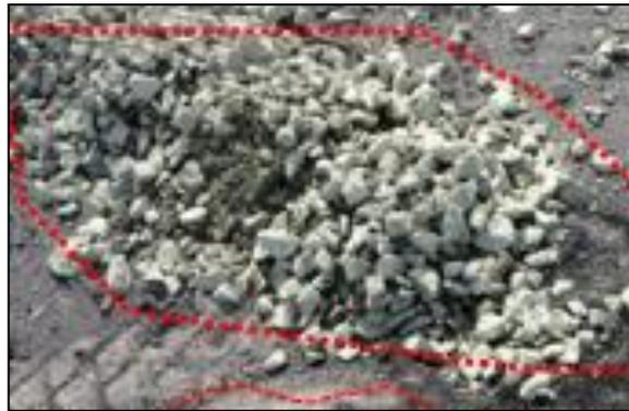
Gambar 6. *Gravel* Dengan Ukuran Butir 1/8 Diameter Lubang Ledak
